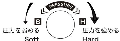
① テープの材質に合わせてローラーの圧力を調整します。
